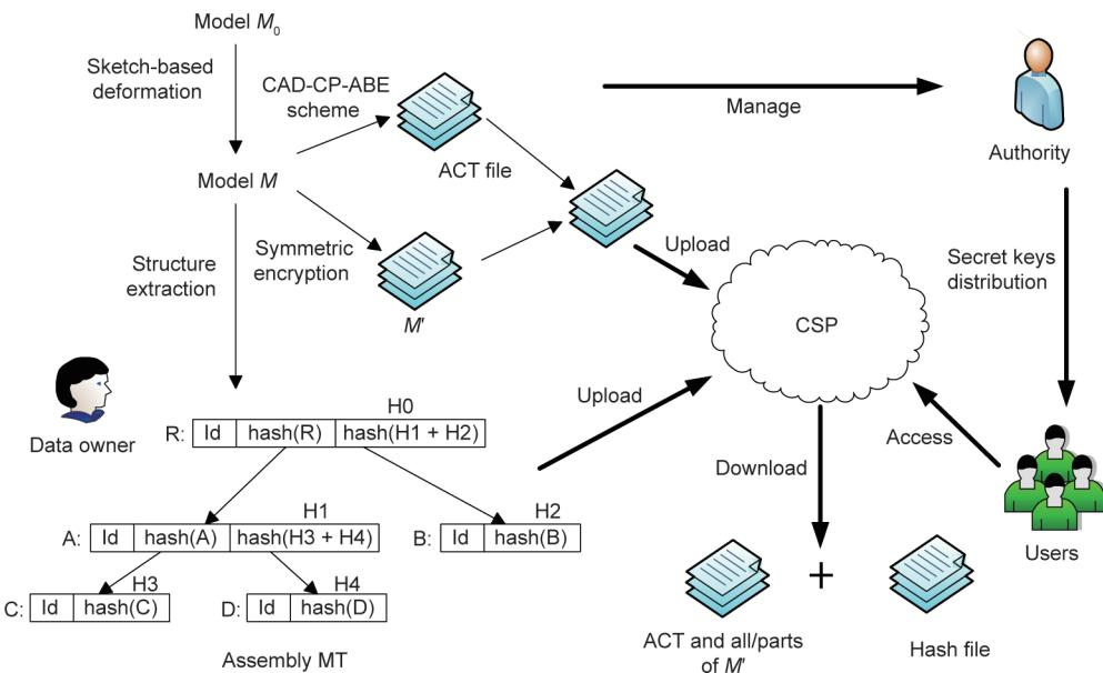
图2. CBDM装配体MT的方法的体系结构。A、B、C、D和R是M的5个文件。 $M_0$ : 初始的CAD装配体模型； $M$ : 变形的CAD装配模型； $M'$ :  $M$ 的密文；Id: 装配体MT中每个文件节点的标识。
