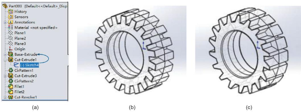
图4. Part003的特征草图变形的示例。(a) SolidWorks中Part003的FeatureManager; (b) 原始Part003; (c) 变形的Part003。
