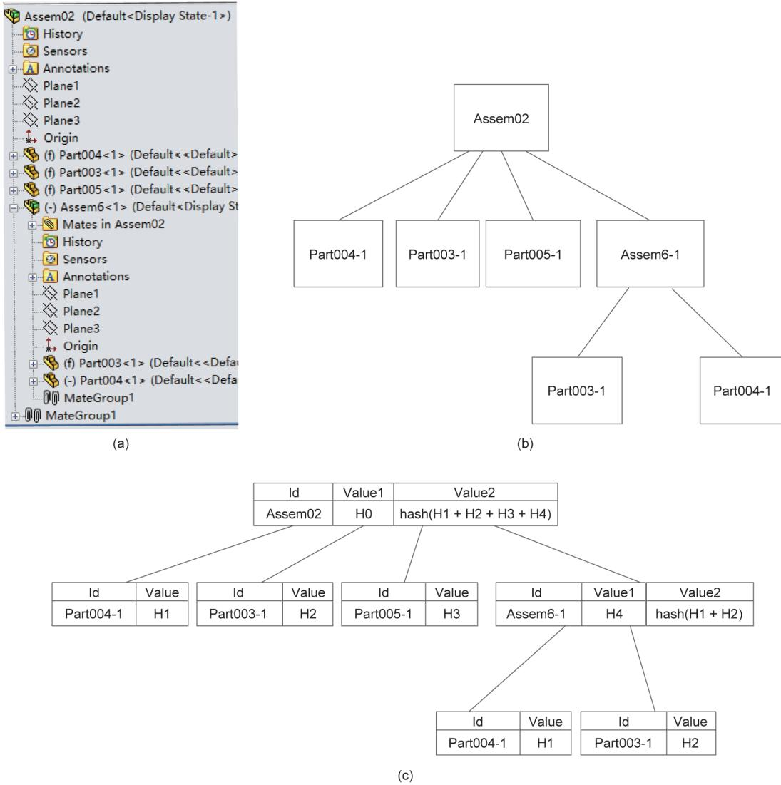
图3. Assem02的说明性示例。(a) SolidWorks中Assem02的装配结构;(b) Assem02的抽象结构树;(c) Assem02的装配体MT。
