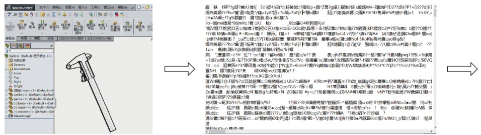
图7. 装配体文件使用AES算法进行加密和解密的示例。
