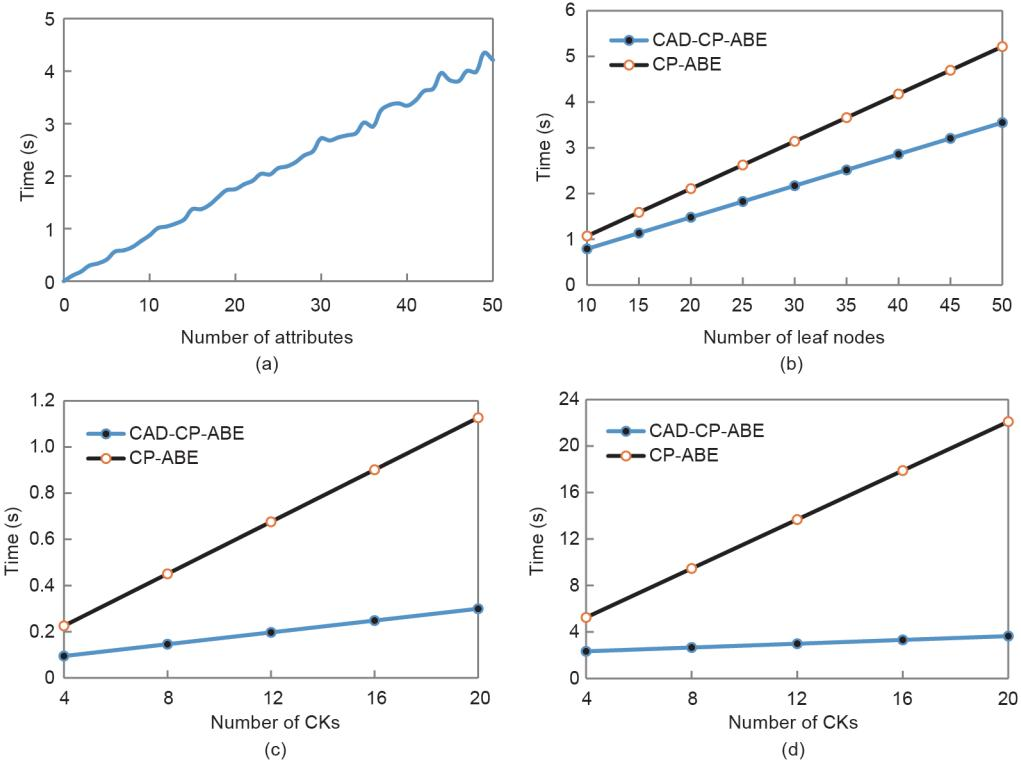
图8. CK加密和解密的实验结果。(a) SK生成时间和所有属性数; (b) 两个CK的加密时间成本; (c) 30个叶节点的加密时间成本; (d) 来自根节点的所有CK的解密时间成本。
