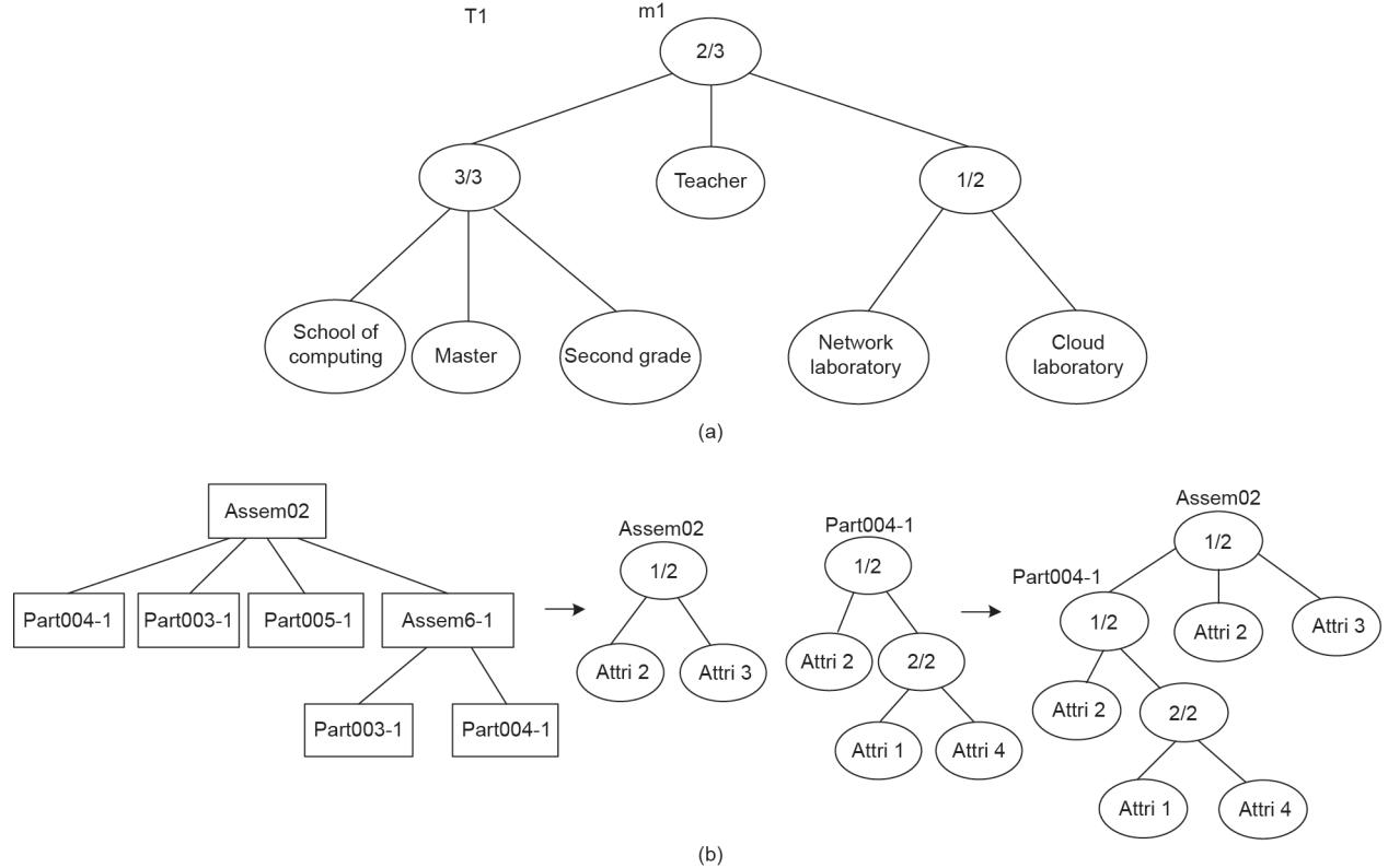
图5. CP-ABE方案中的访问结构示例。(a) 访问结构树的示例。\$T\_1\$是\$m\_1\$的访问结构。(b) \$Assem02\$和\$Part004\$的分层访问结构。Attri: 属性节点(attribute node)。
