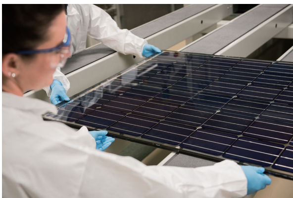
图1. Oxford PV公司位于德国哈维尔河畔勃兰登堡的工厂制造的一组串联硅/钙钛矿太阳能电池。该公司将于2022年推出的首批商用电池的转换效率可达到26%左右。来源：Oxford PV，经许可。
