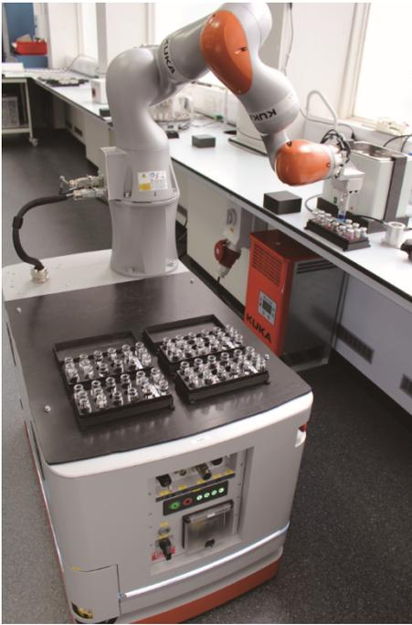
图2. 英国利物浦大学 Cooper 小组实验室运行中的“自动化研究员”。库卡移动机器人（KUKA Mobile Robot）可在82 cm范围内自如移动。该机器人通过结合激光扫描和触摸反馈确定自身的位置，从而进行精确定位。出于安全考虑，它移动缓慢，但与人相比，该机器人系统做实验的速度很快，因为它做实验是批量进行的，且“思考速度如闪电般快”，Andrew Cooper 教授说道。来源：Andrew Cooper，经许可。
