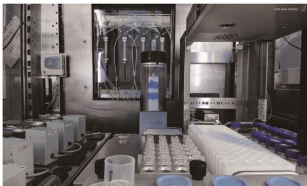
图1. IBM的RoboRXN化学实验室系统合成分子的实时照片。在图的左下方，可以看到自动合成工作站6个反应室中的几个。右边带着蓝色瓶盖的是装有配料的广口瓶。来源：IBM RoboRXN for Chemistry，经许可。
