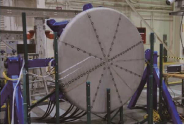
图8. NASA与CSIRO联合开展航天器热防护结构FOSS监测试验验证[30-31]。
