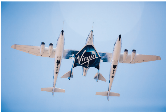
图1. 一次飞行测试中，维珍银河公司的发射平台VMS Eve将航天飞机VSS Unity送入太空。图片来源：维珍银河公司提供（公共图片）。
