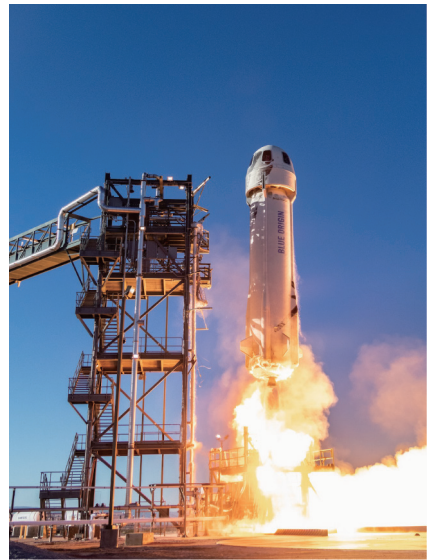
图3. 2019年1月23日，蓝色起源公司的“新谢泼德”航天飞机在可重复使用的助推火箭上发射，搭载了9项NASA实验。请注意机舱上的窗户。图片来源：由Blue Origin提供（公共图片）。
