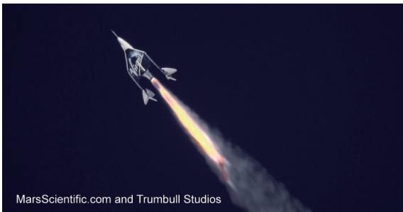
图2. 2019年2月22日的飞行测试中，维珍银河公司用于太空旅行的航天飞机VSS Unity飞至55.85mi（89.9 km），搭载3名乘客：两名驾驶员和一位航空专家。图片来源：出自MarsScientific.com和Trumbull工作室，由维珍银河公司提供（公共图片）。
