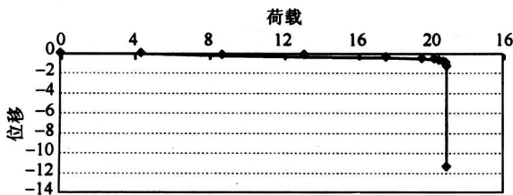
图 39 地基在增量加载全过程中荷载—位移响应
