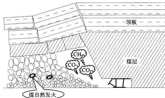
图1 坚硬厚煤层综放开采的灾害因素示意图
