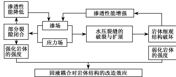
图5 固液耦合作用下裂隙岩体的结构改变关系
