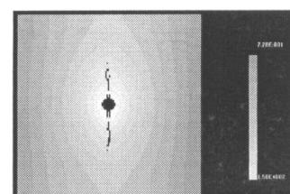
图 3 水力致裂钻孔围岩水力等值线分布
