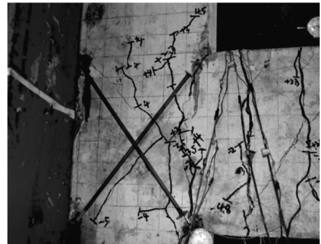
图3 T-5破坏形态与节点裂缝图
