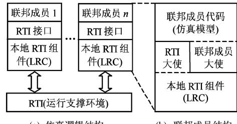
图 1 HLA 仿真逻辑结构和联邦成员结构
