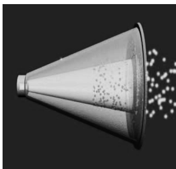
图 8 收集质子电荷的同轴法拉第筒结构
