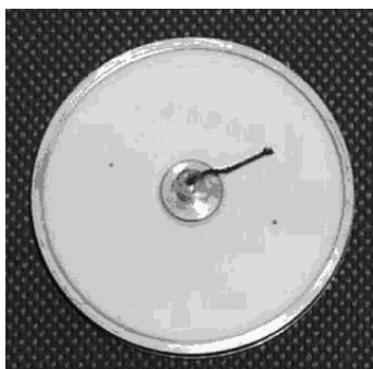
图 7 收集质子能量的电流型 PIN 探测器
