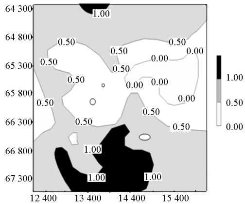
图4 煤与瓦斯突出危险区域等值线图(单位:m)
