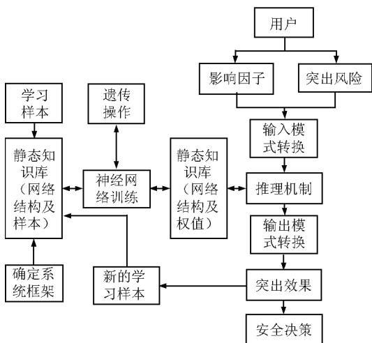
图3 煤与瓦斯突出区域预测模型
