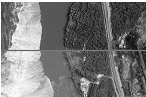
图 13 利用多片匹配结果进行无控制 POS 平差后生成的正射影像
