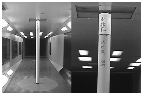
图 2 横桥向风荷载试验装置
