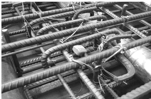
图 2 32 m 箱梁某测点应变计
