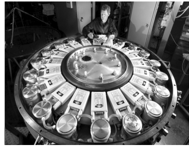
图2 500 kA FLTD 除去上盖后的照片
