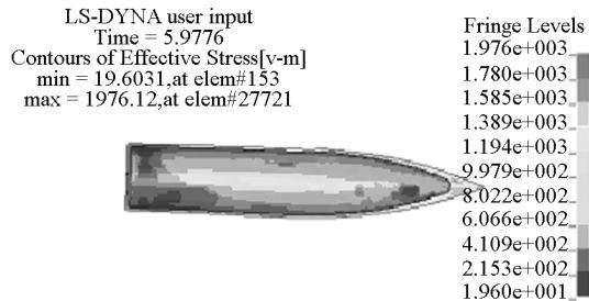
图 2 弹体以 300 m/s 速度、60°落角穿靶后弹体结构变形情况
