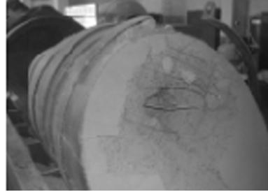
(c) 实验后混凝土靶图片
