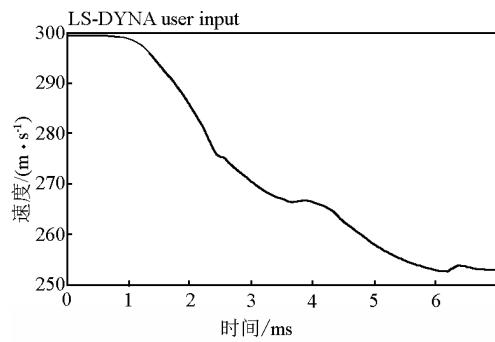
图 3 弹体以 300 m/s 撞击速度垂直贯穿混凝土靶板过程中的弹体速度
