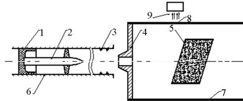
图 4 弹体斜侵彻混凝土靶板示意图
