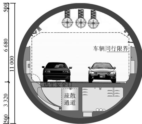
图3 隧道横断面设计图(单位:mm)
