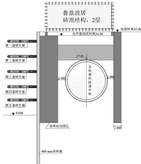
图8 鲁兹故居加固示意图
