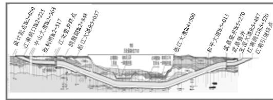
图2 隧道纵断面设计图
