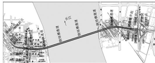
图1 武汉长江隧道线路平面图
