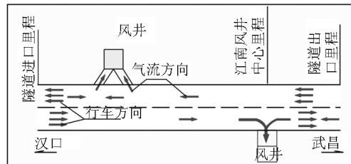
图5 通风方式选择及污染空气排放方式
