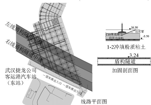
图7 线路与防洪堤的位置情况及防洪堤加固情况
