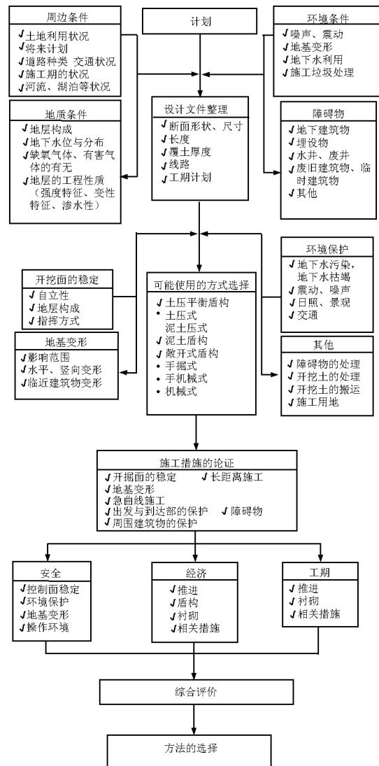
图6 盾构选型流程图
