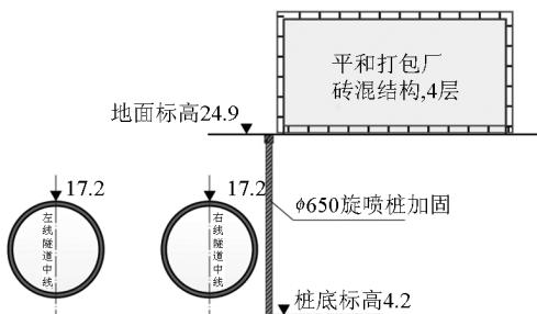
图9 平和打包厂加固示意图
