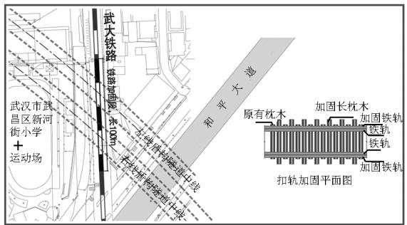
图 10 武大铁路加固示意图
