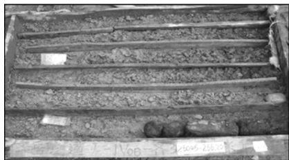
图3 F11断层地表钻孔取心照片
