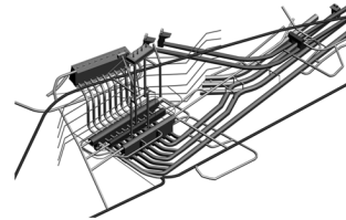
图 2 某大型地下厂房洞室群布置示意图
