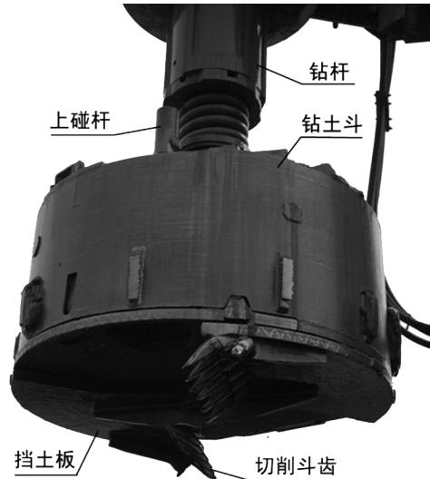
图2 旋挖钻机的钻头
