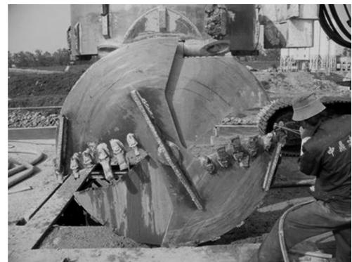
图 5 修复钻头上的齿板
