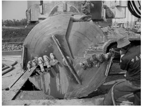
图 5 修复钻头上的齿板
