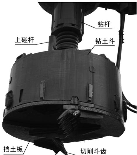
图2 旋挖钻机的钻头
