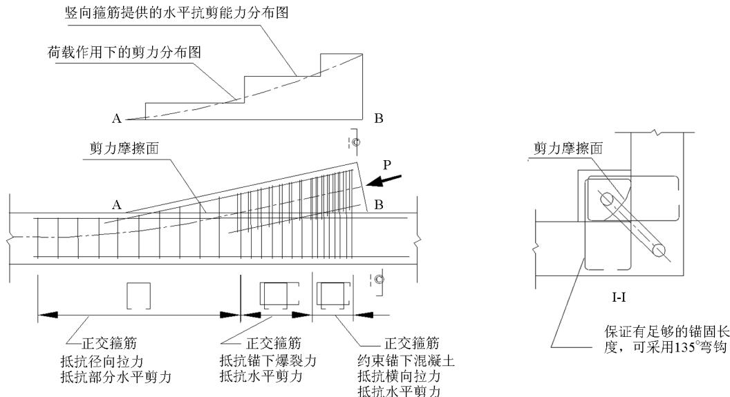
图5 齿板锚固区钢筋布置示意图
