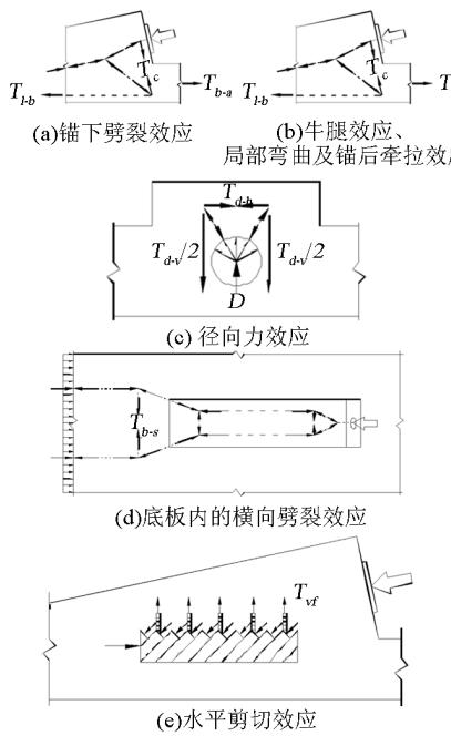
图 2 齿板内的 7 种局部作用效应
