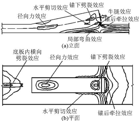
图 1 齿板内主拉应力等值线
