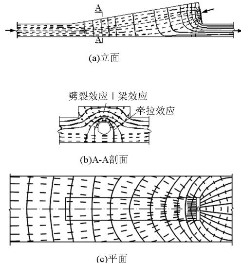
图 3 齿板锚固区的主应力迹线
