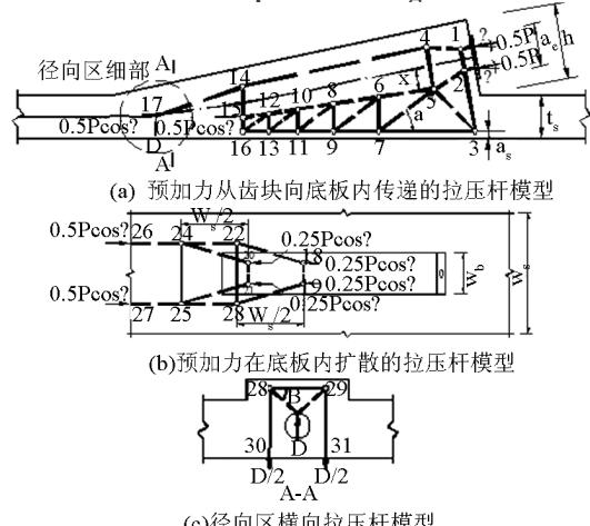
图 4 齿板锚固区拉压杆模型
