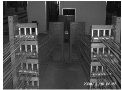
图5 过线架及分丝板
