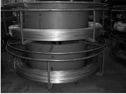
图1 改制放线架结构相片
