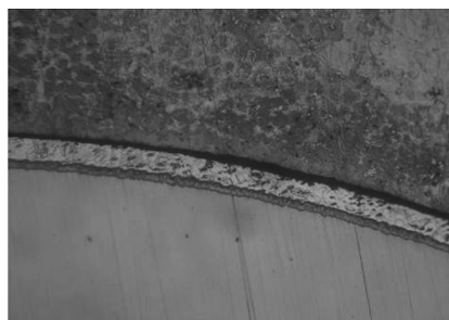
图9 过渡层 0.02 mm (使用清洗助镀液)
