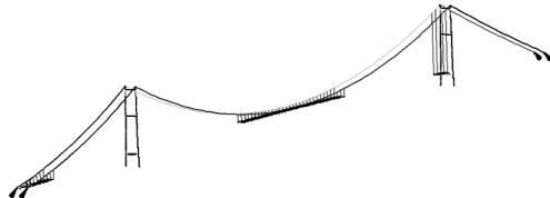
图2 西堠门大桥结构离散模型
