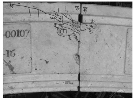
图 24 B5 块外侧接缝处剪坏
