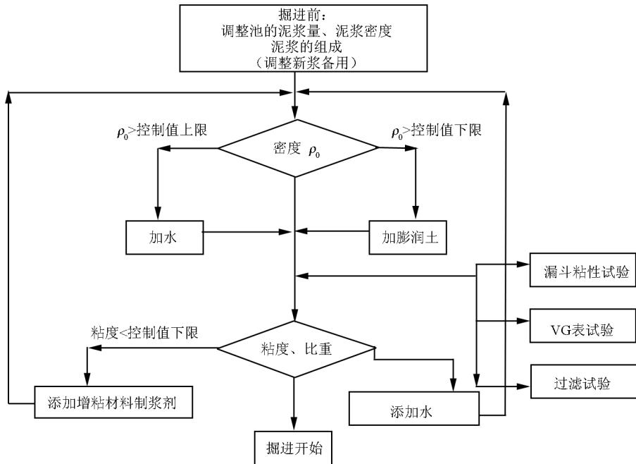
图 1 泥浆过程控制流程图
