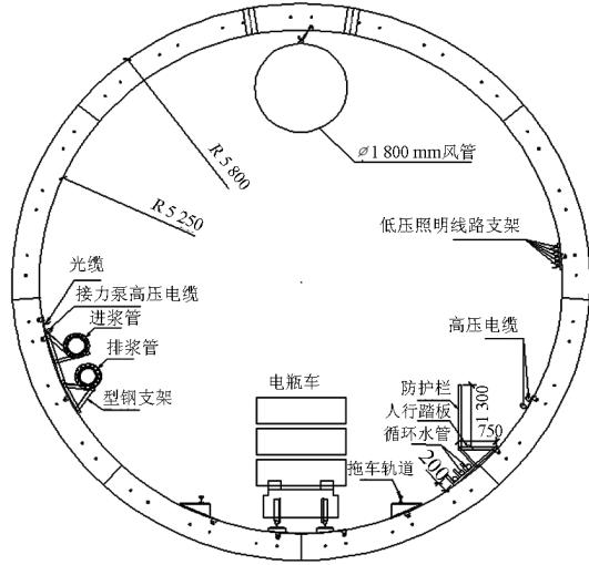
图8 管线换装后隧道内布置图(单位:mm)
