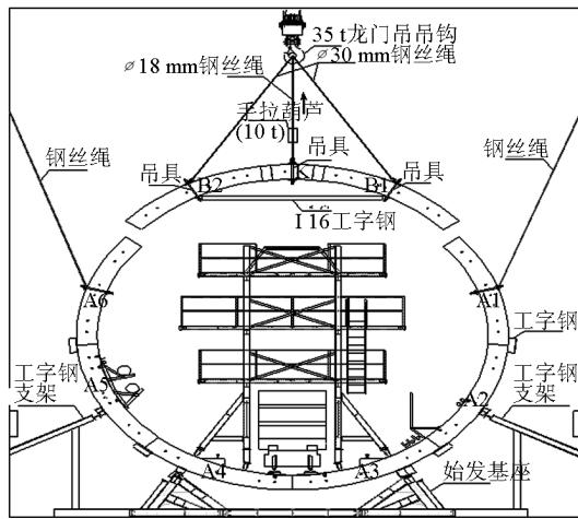
图4 负8环K、B1和B2块管片拆除图
