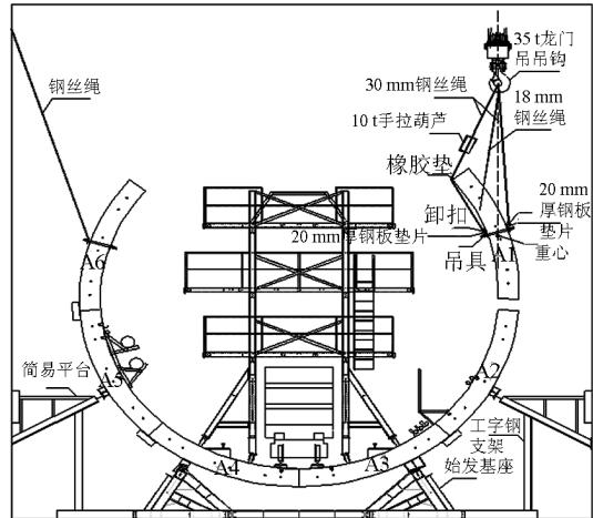
此负环底部剩余的2~3块管片是交错排列,不是恰好两块整片,底部多余部分的管片用绳锯切割拆除。首先以负8环管片底部剩余的2块管片的上边缘为基准线,在其余负环底部剩余的3块管片内弧面沿水平划一道线,作为管片切割线。然后在需要切割的管片上半部分用水钻钻孔,安装吊具和钢丝绳。接着安装绳锯沿切割线将管片切断,最后用龙门吊将切除的管片吊至地面。管片切割拆除如图6所示。
