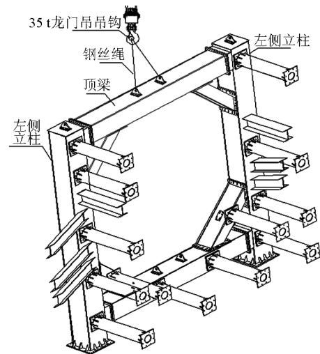
图2 反力架横梁拆除示意图
