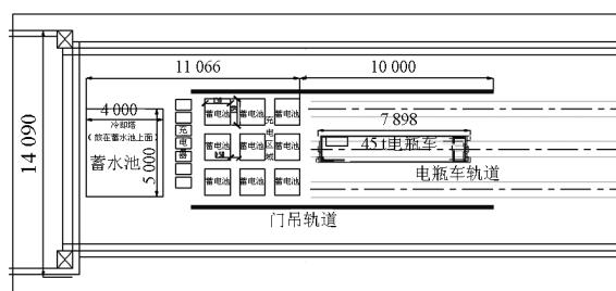
图10 后盲洞冷却塔及充电房布置(单位:mm)
