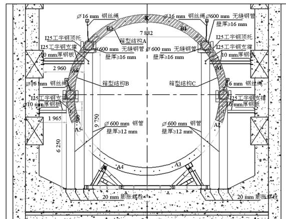
图7 临时支撑安装横剖面图(单位:mm)
