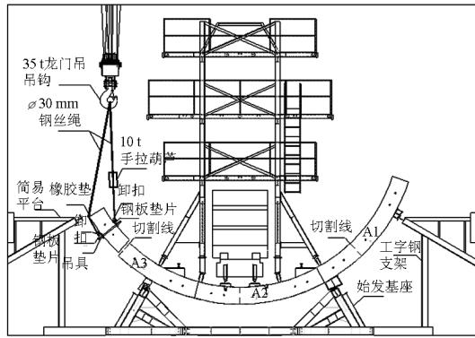
图6 负环管片切割示意图
