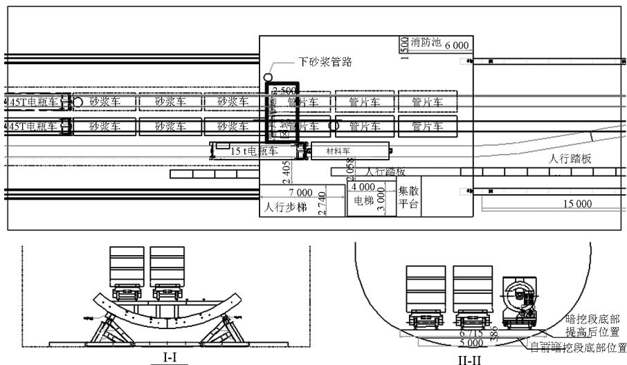
图9 轨道换装布置图(单位:mm)
