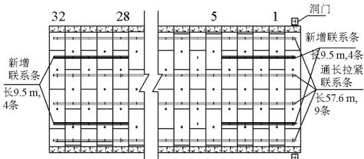
图1 纵向拉紧联系条布置图
