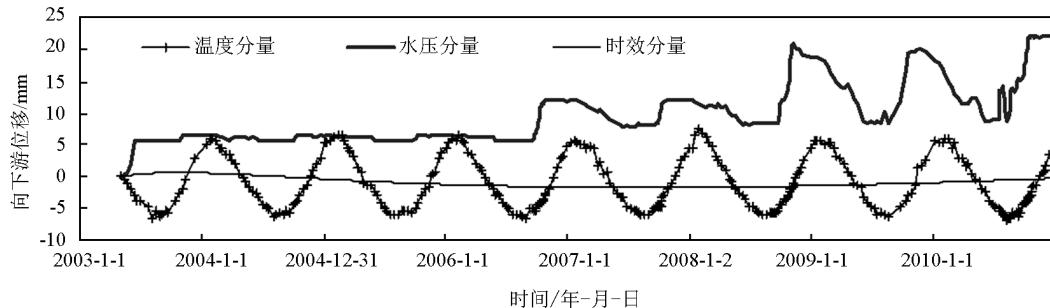
图 2 泄 2 号坝段坝顶向下游位移统计模型各分量过程线
