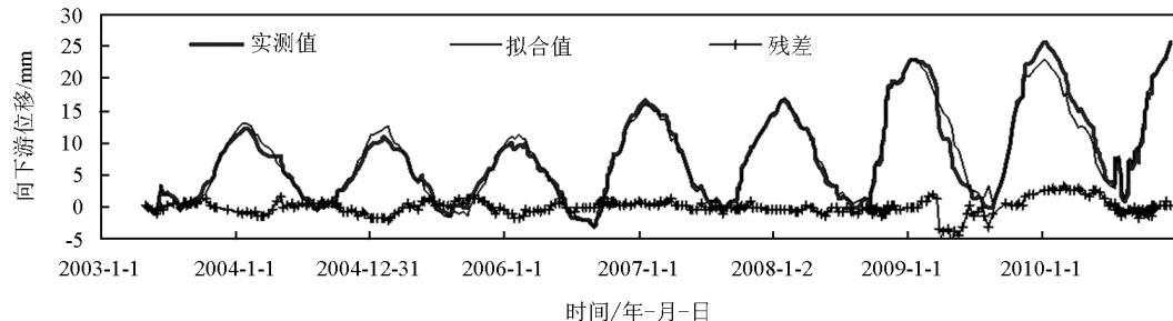
图 1 泄 2 号坝段坝顶实测向下游位移及其拟合值过程线
