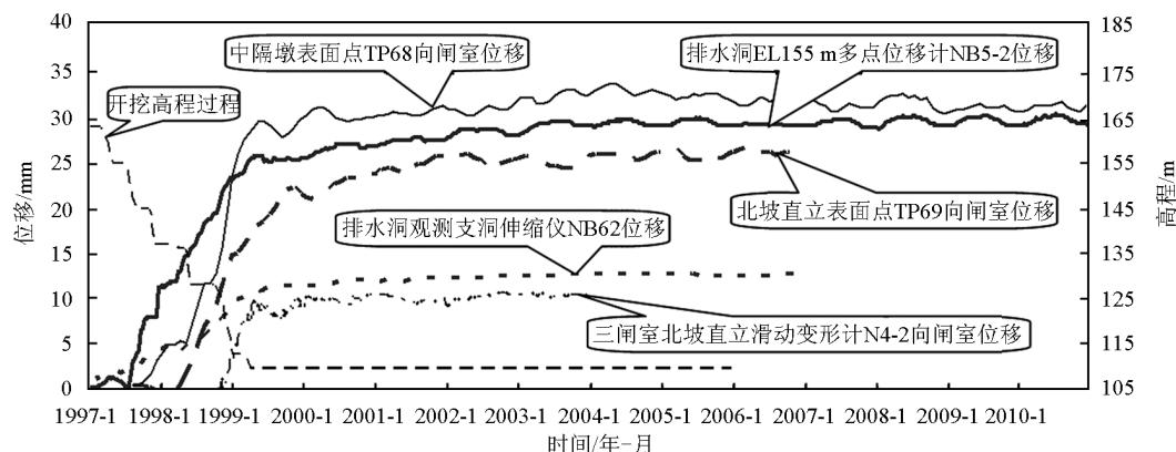
图3 各监测设施典型测点观测的闸室向位移过程线
