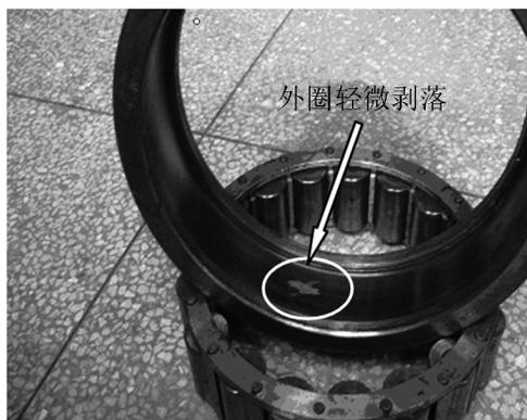
图 8 机车滚动轴承外圈损伤
