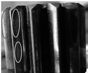
图 17 行星减速器太阳轮齿损伤
