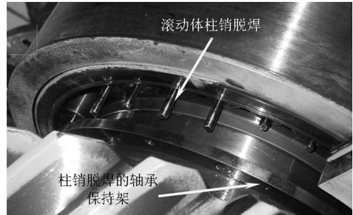
图4 轴承保持架结构及损坏状况图
