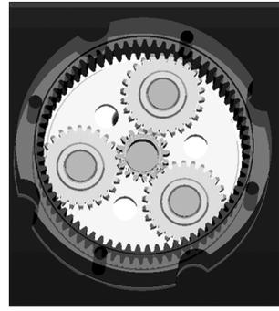
图 15 行星减速器第一级传动机构
