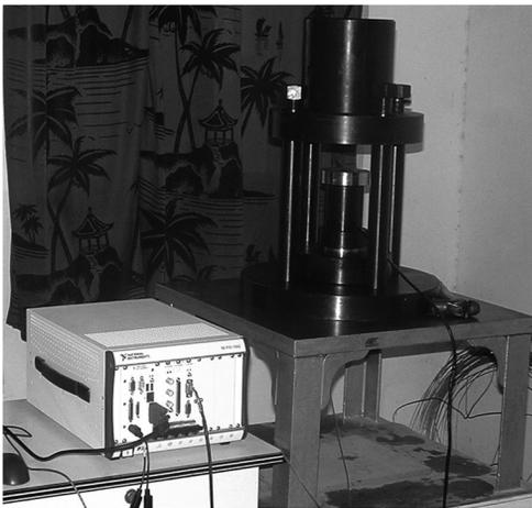
图8 发射装药动态挤压破碎试验装置
