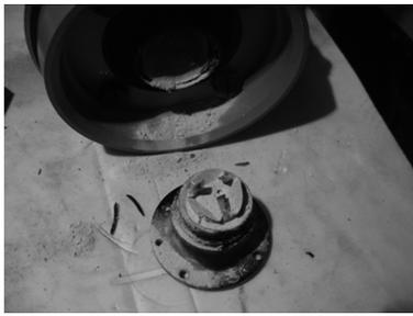
图 11 发动机堵头上的硫酸铜粉末变蓝
