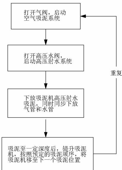
图 3 冲洗法吸泥工艺流程图
