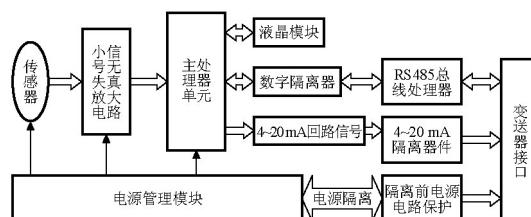
图 6 压力传感器智能数字变送器系统框图
