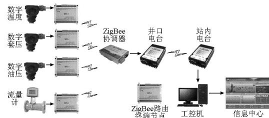
图 8 Zigbee 系统总体架构
