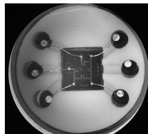
图5 键合与高温充硅油封装实物图
