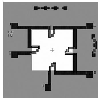
图2 方膜高温高压传感器
