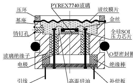
图4 充硅油压力传感器结构
