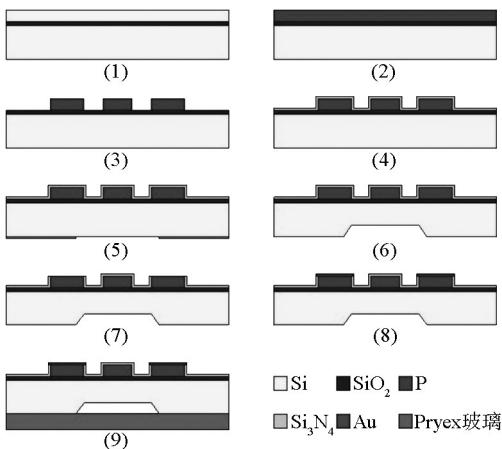
图3 高温高压传感器芯片加工工艺流程
