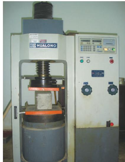
图2 抗压试验装置
