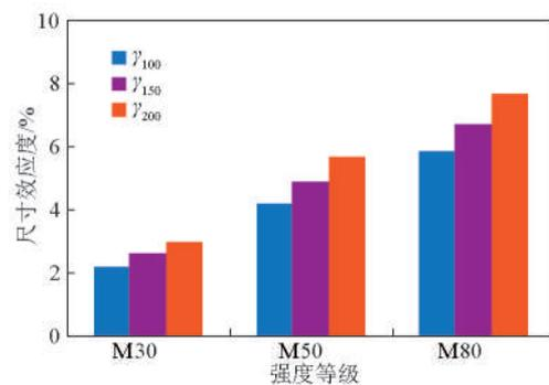
图4 不同强度等级试件的尺寸效应度  $\gamma$
