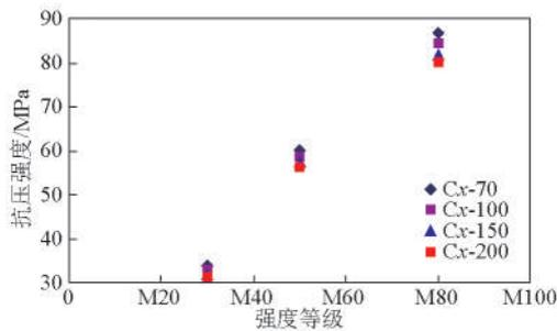
图3 水泥砂浆立方体抗压强度
