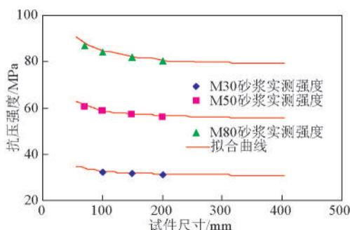
图5 尺寸效应率拟合曲线
