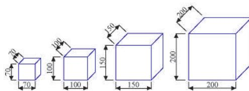
图1 水泥砂浆试件尺寸(单位:mm)
