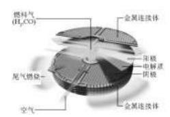
图 1 Hexis AG 平板式 SOFC Fig.1 Hexis AG planar solid oxide fuel cell
