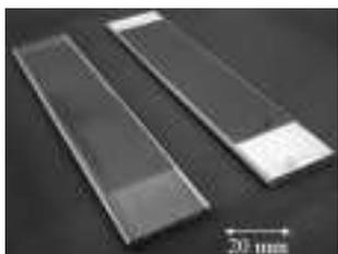
图 6 Osaka Gas 和 Nippon Oil 制造家用 CHP 所采用的 Kyocera 阳极支撑扁管电池
