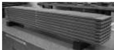
图8 Delta 8电池按照1×8串联的方式组装的5 kW电池堆
