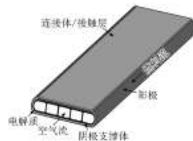
图 6 HPD5 电池设计示意图
