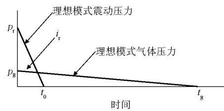
图3 内爆炸荷载简化形式<sup>[2]</sup>
