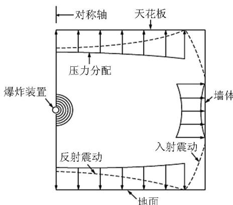
图1 结构内部冲击波反射示意图<sup>[1,2]</sup>
