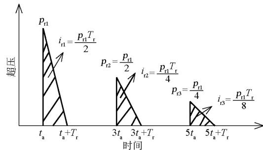
图2 结构内爆炸冲击波超压简化形式<sup>[1]</sup>
