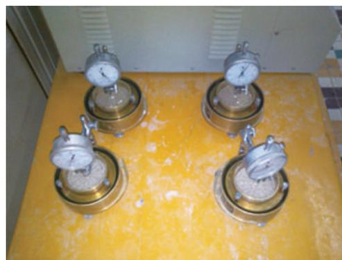
图 1 无荷膨胀率试验
