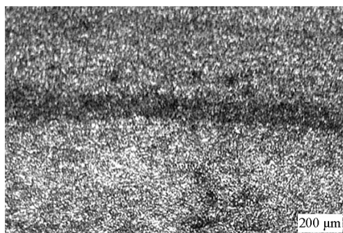
图9 板材中心疏松线照片
