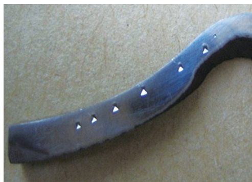
图7 着弹点隆起截面和硬度测定点照片
