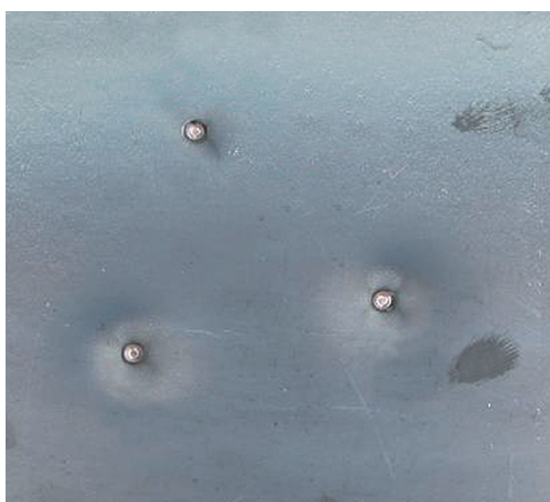
图6 距离10 m射击后的钢板照片
