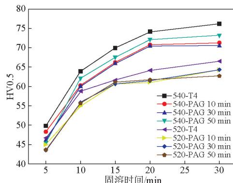
图1 合金不同条件下固溶+80 °C预时效后的硬度分布
