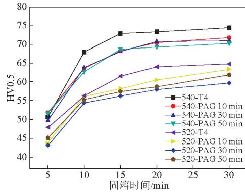
图2 合金不同条件下固溶+100 °C预时效后的硬度分布
