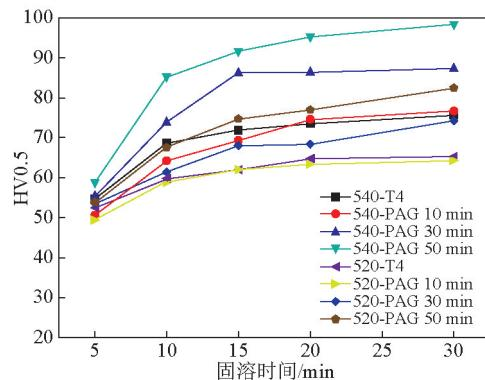
图3 合金不同条件下固溶+170 °C预时效后的硬度分布
