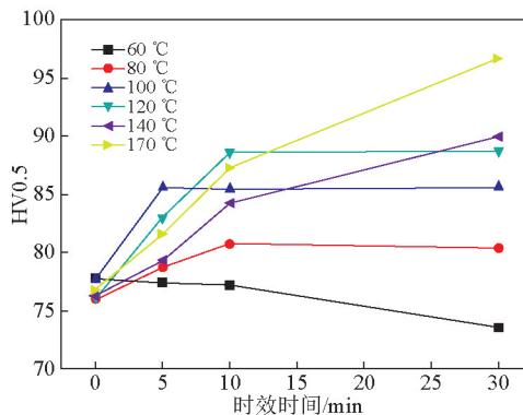
图5 合金不同工艺预时效+170 °C×30 min烘烤后的硬度分布
