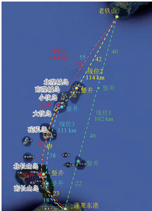
图5 几种对比的隧道线位(单位:km)
