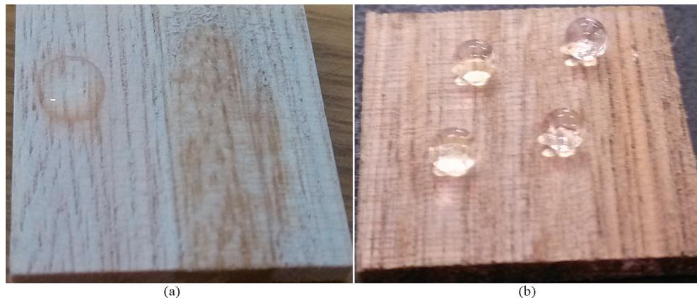
图3 水滴在未处理的木材(a)和超疏水木材(b)表面的数码照片
