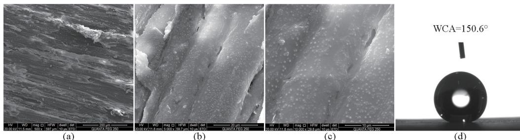
图2 超疏水木材的低倍( $\times 500$ )(a)和高倍( $\times 5\,000$ (b), $\times 10\,000$ (c))SEM图像及接触角测试图(d)
