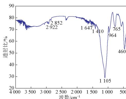
图5 超疏水样品的FTIR谱图
