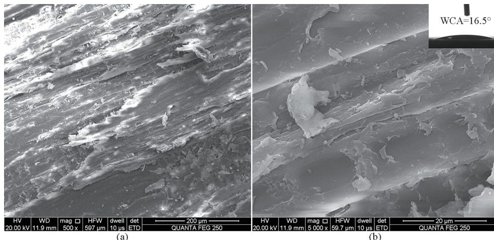
图1 纯木材的低倍( $\times 500$ )(a)和高倍( $\times 5 000$ )(b)SEM图像
