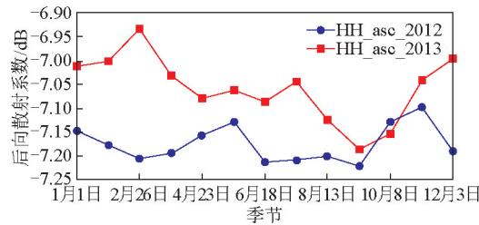
图7 HY-2卫星微波散射计HH极化下午升轨测量后向散射系数随季节的变化
