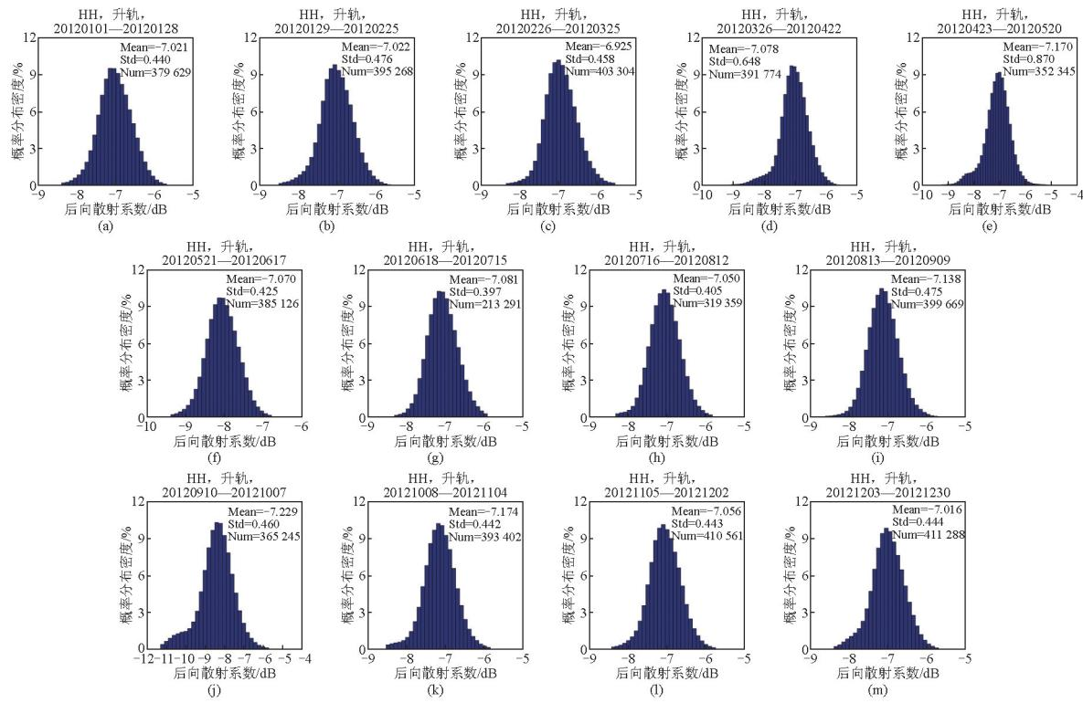
图5 HY-2卫星微波散射计HH极化升轨后向散射系数的直方图分布(2013年)
