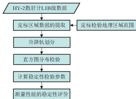
**图2 HY-2卫星散射计仪器测量稳定性检验的数据处理流程图**
