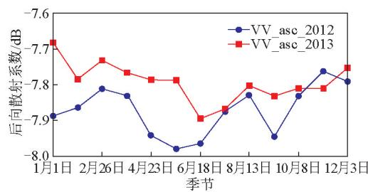
图8 HY-2卫星微波散射计VV极化下午升轨测量后向散射系数随季节的变化
