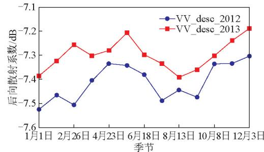
图10 HY-2卫星微波散射计VV极化早上降轨测量后向散射系数随季节的变化
