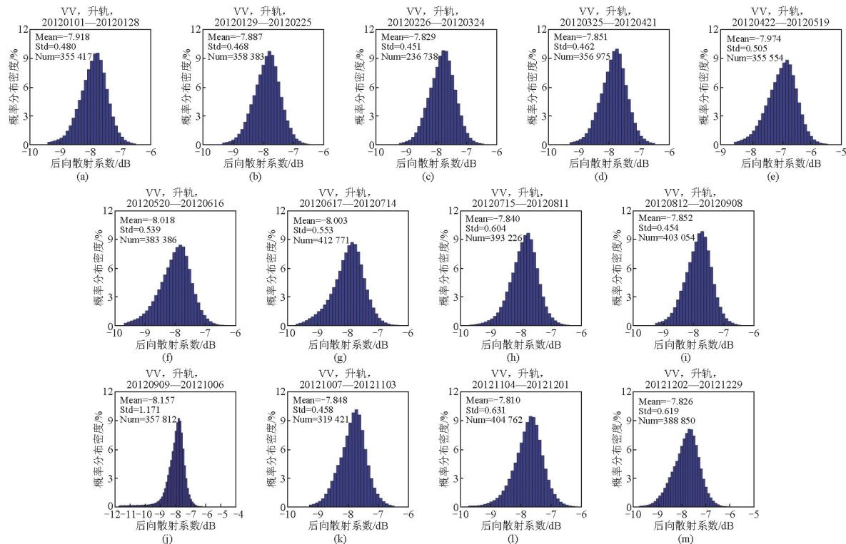
图4 HY-2卫星微波散射计VV极化升轨后向散射系数的直方图分布(2012年)
