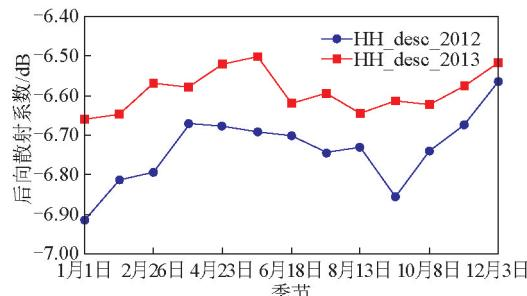
图9 HY-2卫星微波散射计HH极化早上降轨测量后向散射系数随季节的变化
