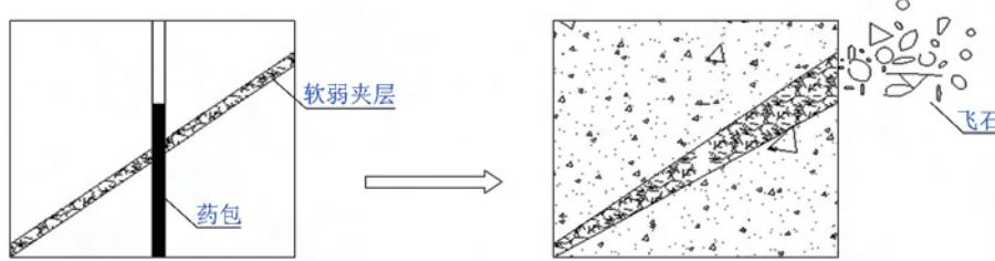
图1 碎石沿结构面方向飞出示意图
