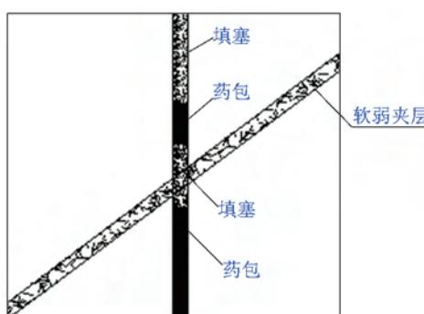
图4 错开软弱夹层装药示意图
