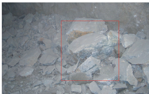
(a) 扇形中深孔爆破效果
