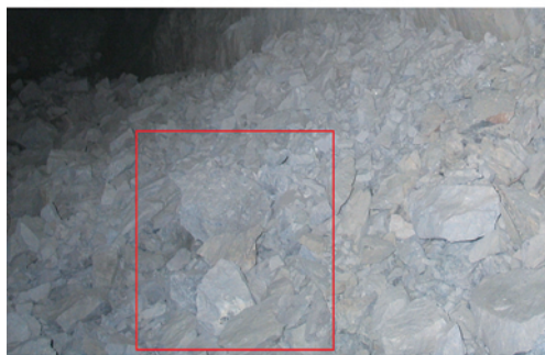
(b) 环形中深孔爆破效果
