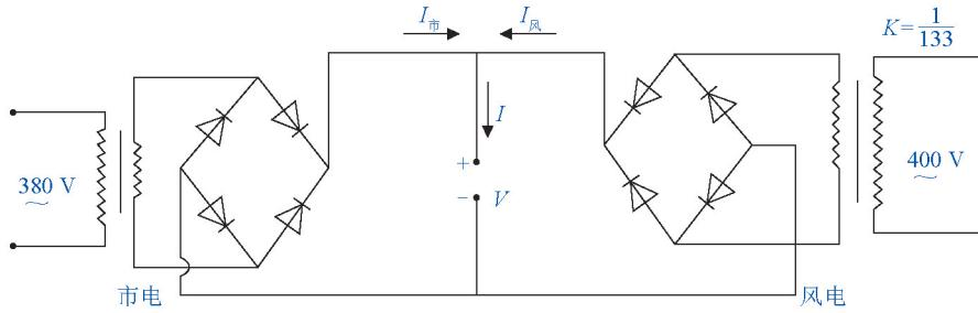
图 4  $I_{\text{风}}, I_{\text{市}}$  协同供电示意图
