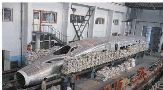
图13 车体静强度试验 Fig. 13 Static strength test of car-body
