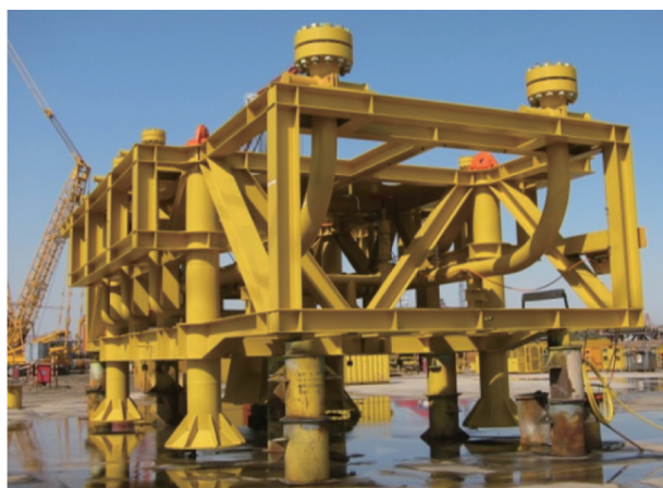
图 8 自主研制水下管汇原理样机
