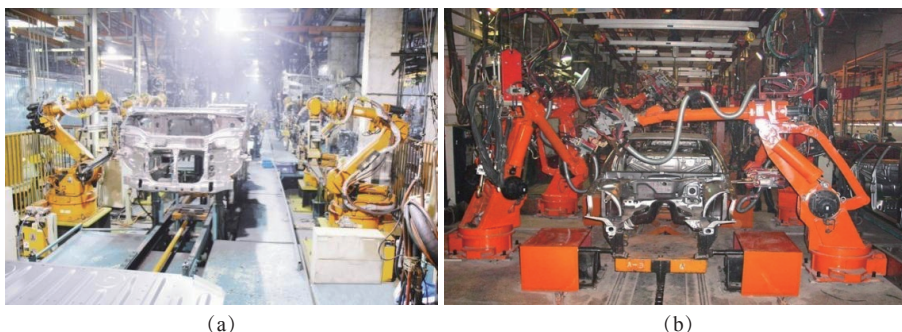
图3 汽车车身智能焊接车间
